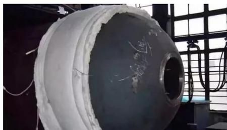
图1 压力容器的热处理
