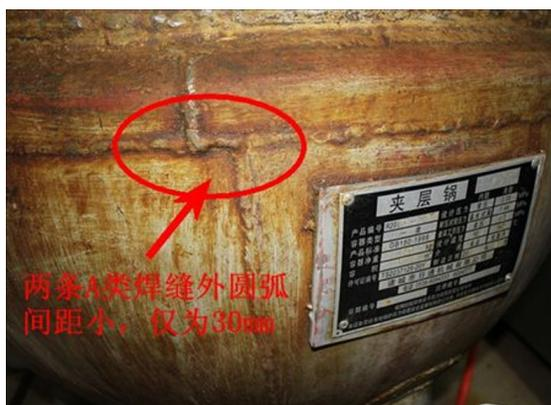
图2 压力容器因焊接发生形变
